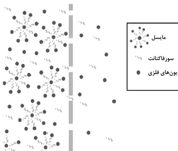
شکل ۱- نمایی از فرایند اولترافیلتراسیون بهبودیافته به کمک مایسل [۲۴]
