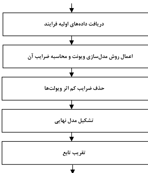
شکل ۱۹- فلوجارت چگونگی انجام مدل‌سازی و حذف سروصدا همزمان
