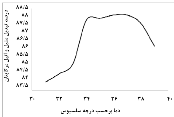
شکل ۳- میزان تبدیل مرکاپتان موجود در پروپان بر حسب دمای استخراج (غلظت سود سوزآور ۱۴/۲ درصد وزنی)
