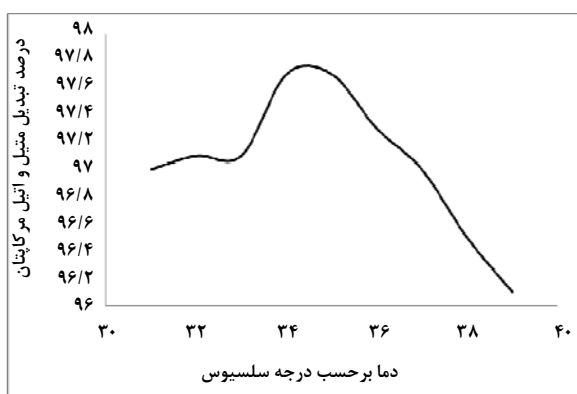
شکل ۳- میزان تبدیل مرکاپتان موجود در پروپان بر حسب دمای استخراج (غلظت سود سوزآور ۱۴/۲ درصد وزنی)
