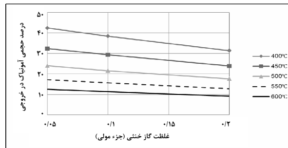
شکل ۳- اثر گاز خنثی بر تبدیل آمونیاک در دمای ۷۰۰°F و فشار ۳۰۰
